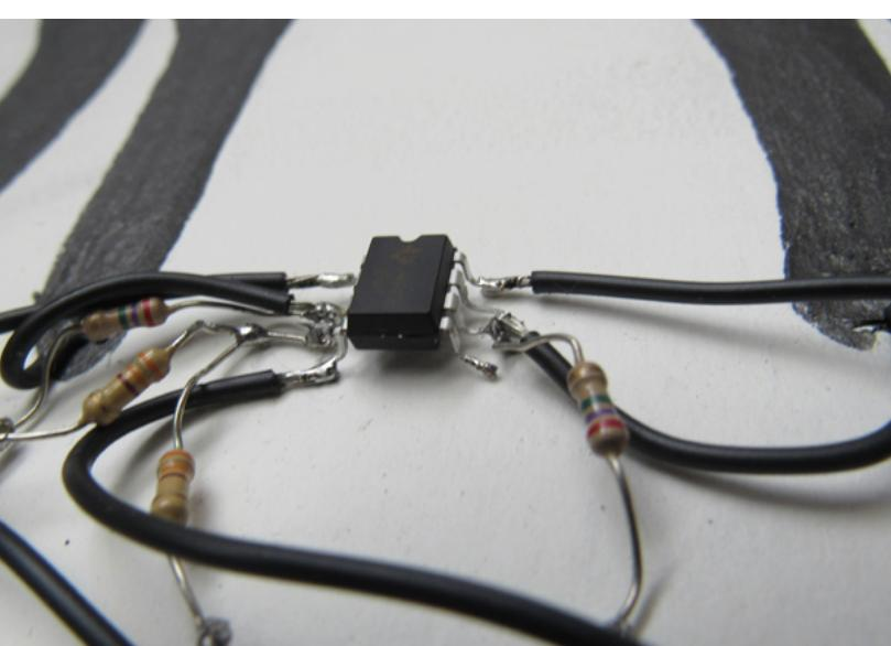
En este circuito se separan dos trazados de grafito, al hacer contacto con la mano cambia el estado de encendido o apagado de leds, o de frecuencia en el caso del sonido
