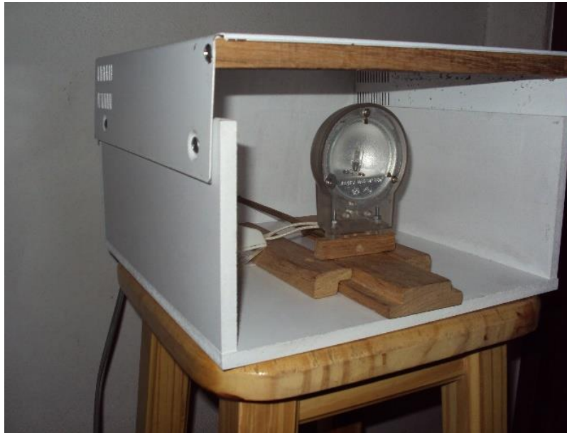
Eugenia Rossi, Caja-proyector de fibrofácil y tapa de aluminio, con la lámpara en un riel móvil.
